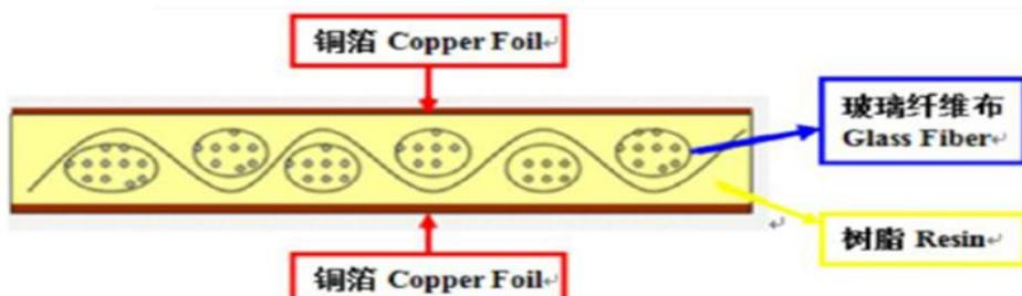
半固化片通常由玻璃纤维布（又称玻纤布）作为增强材料，在玻纤布表面均匀涂布特别调配的树脂后，经上胶烘干后制成，俗称胶片。半固化片的主要作用电路绝缘，并粘结固定铜箔电路。
